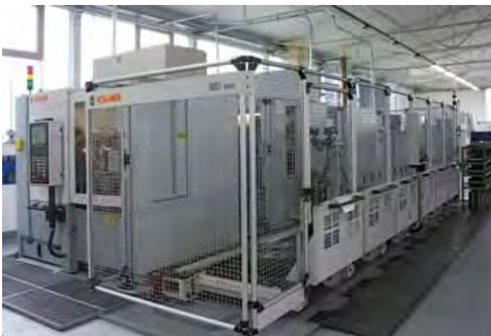
Herzstück der Kreissägenproduktion: Mit dem Schleifzentrum samt automatischer Zuführung ist eine Rund-um-die-Uhr-Produktion möglich
