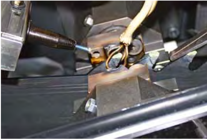
Mit dem Stellitierautomaten GPA 200 wird im Plasmaverfahren punktgenau der Stellite auf den Zahn aufgebracht
