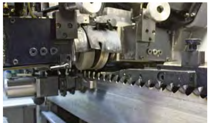
Die CAF 310 bearbeitet in zwei Durchgängen sauber die Flanken der Gattersägen
