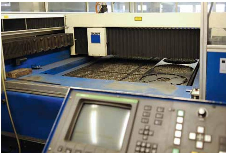
**Herstellung der Rohlinge:** Die Blätter werden mit hoher Genauigkeit gelasert
